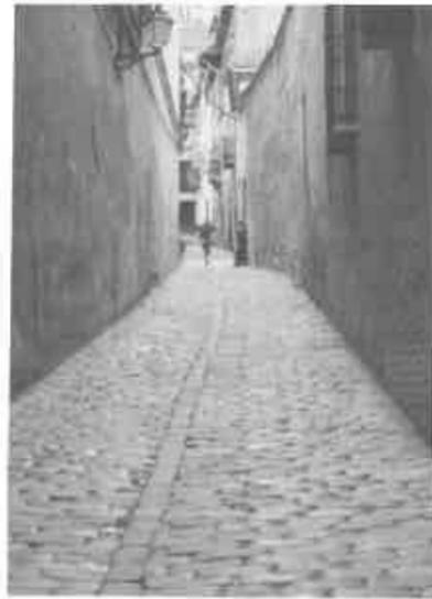
En este adoquinado podemos apreciar su perfecta funcionalidad —la línea central como un canalillo para que circule el agua— y su belleza: la calidad del mismo por la riqueza de textura de los adoquines, que por el uso han sido modelados distintamente, pulimentados, y el tono marfileño, que da una luminosidad a este angosto callejón. Textura y color son elementos del pavimento que pueden, como en este caso, cualificar todo un ambiente urbano.
