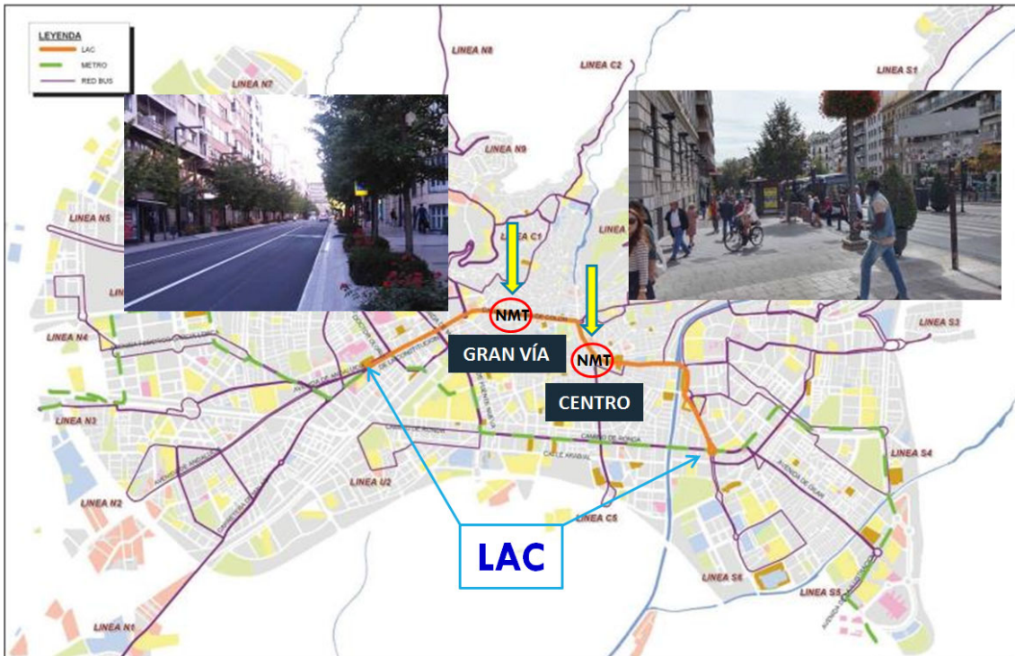
Figura: Trazado de la LAC ( naranja ) con indicación de los monitores fijos (NMT) instalados en GRAN VÍA y CENTRO para su análisis y supervisión acústica.
