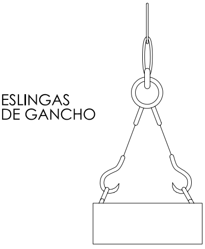
SISTEMA INCORRECTO (GANCHOS HACIA DENTRO)
