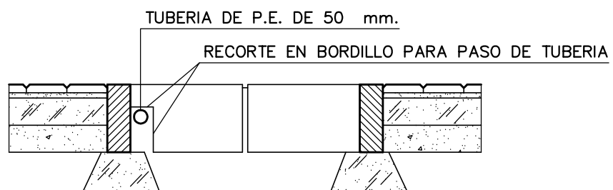
SECCION C-C' LONGITUDINAL PASO DE TUBERIA ESCALA 1:20
